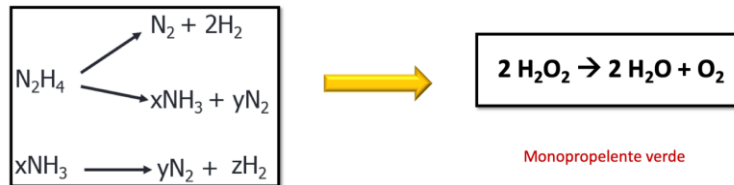
Figura 2. Reações químicas de decomposição da hidrazina e do peróxido de hidrogênio.
